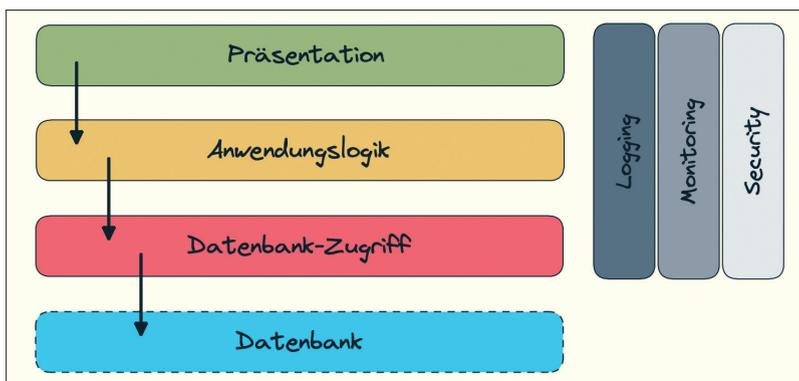
3-Schichten-Architektur mit übergreifenden Aspekten und Datenbank (Bild 1)
